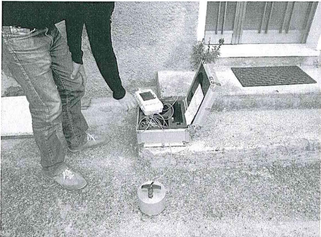
Foto 1: Esecuzione dell'Indagine Sismica Passiva con tecnica "HVSr" n° 1, Sensore sismico 3D frequenza 2Hz e Sismografo digitale Vibralog a 24 bit (M.A.E.)
